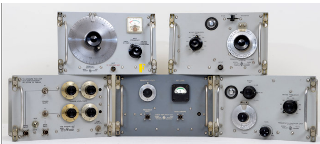
Imagem 4 - Conversores de frequência, HP525 B, o segundo na fila de cima; HP525A, o terceiro na fila de baixo. Fonte: www.hparchive.com .
